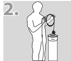
Deslice la bola desde el extremo superior de la chimenea hasta que aparezca por el extremo inferior.
