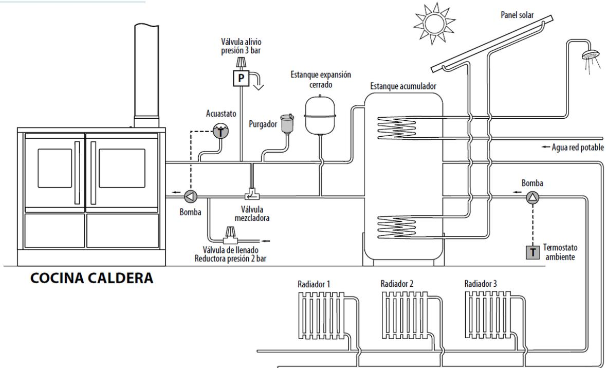
Este tipo de instalación incluye un **estanco acumulador** (Producción ACS o multipropósito ACS), el cual permite almacenar agua caliente para optimizar el uso de la caldera, mejorar la eficiencia del sistema y asegurar una entrega continua de energía térmica incluso cuando la caldera no está encendida. además **producir agua caliente sanitaria** (ACS), destinada al consumo doméstico: duchas, lavamanos, cocina, etc
