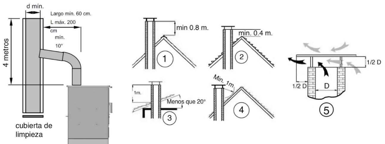
*Conexión de humos de acero con doble Cámara (kit de instalación)*
