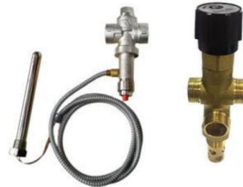
Este componente permite controlar situaciones de emergencia como el corte eléctrico, donde la bomba circuladora se detiene y el agua puede alcanzar temperaturas peligrosas. Al activarse, la válvula permite la entrada de agua fría y la evacuación del agua caliente, evitando daños mayores.
