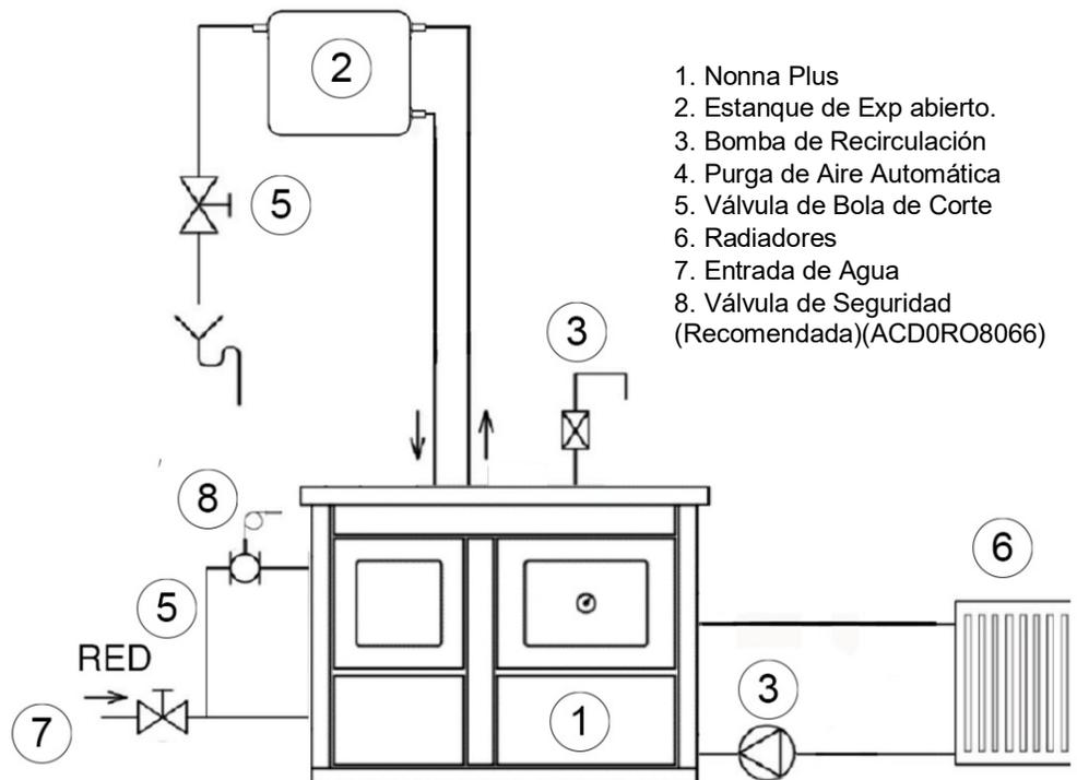
En este tipo de instalación, la caldera se conecta directamente a un circuito de radiadores, utilizando un **estanco de expansión abierto**, el cual permite mantener la presión del sistema prácticamente constante, incluso en caso de ebullición del agua.
