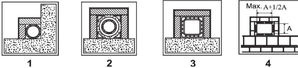
1. Conducto de humos de acero con doble cámara, aislado con material resistente a 400 °C. **Rendimiento: excelente.**
